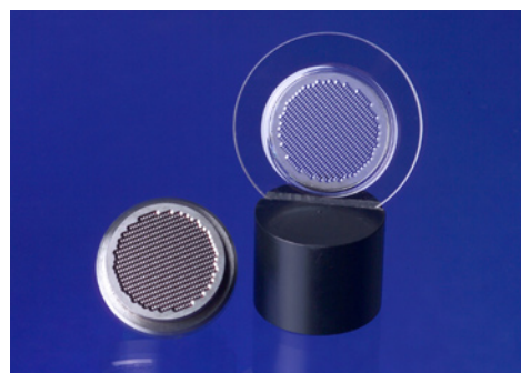
Bild 2: Doppelseitig geprägtes Linsenarray für besonders kleine Hochleistungsprojektoren. Die sog. Wabenkondensoren bestehen aus einem einzelnen runden Bauteil mit einer Vielzahl an Einzellinsen und können die Optiken der Projektoren deutlich verkürzen. Ein rechteckiges Feld lässt sich auf diese Weise mit hoher Effizienz einheitlich ausleuchten. Quelle: Fraunhofer IPT.
